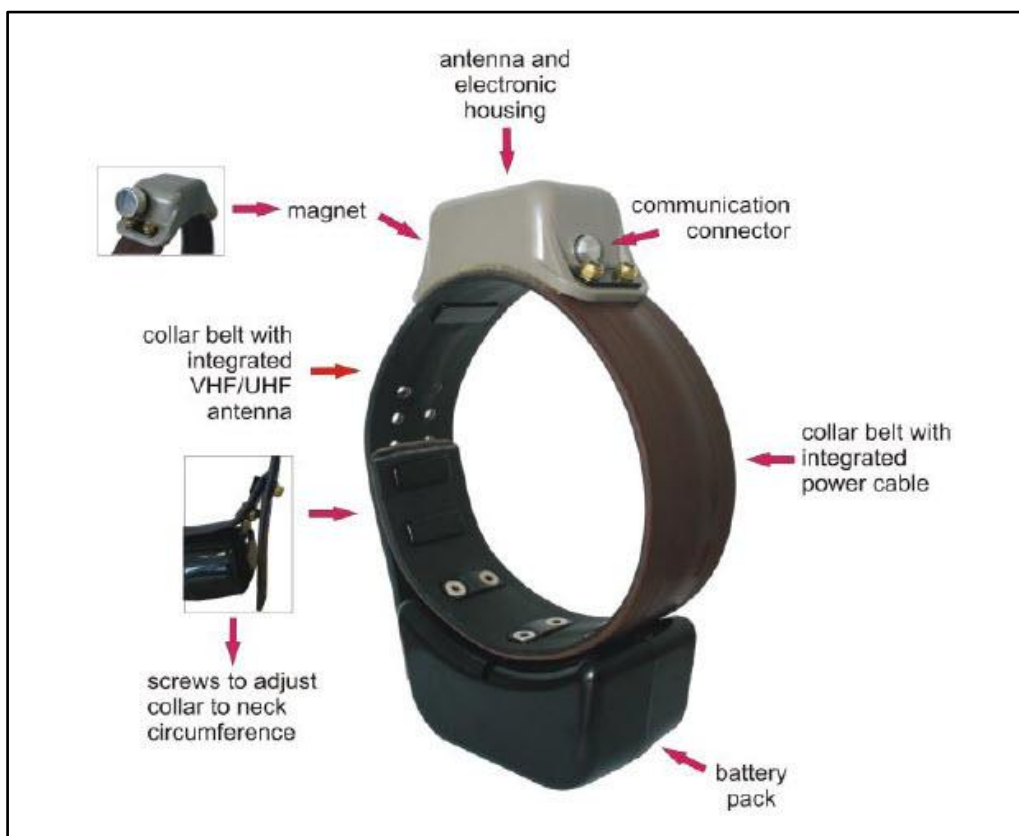
ภาพที่ 3 แสดงลักษณะของปลอกคอสัญญาณดาวเทียม (Satellite GPS Collars)
