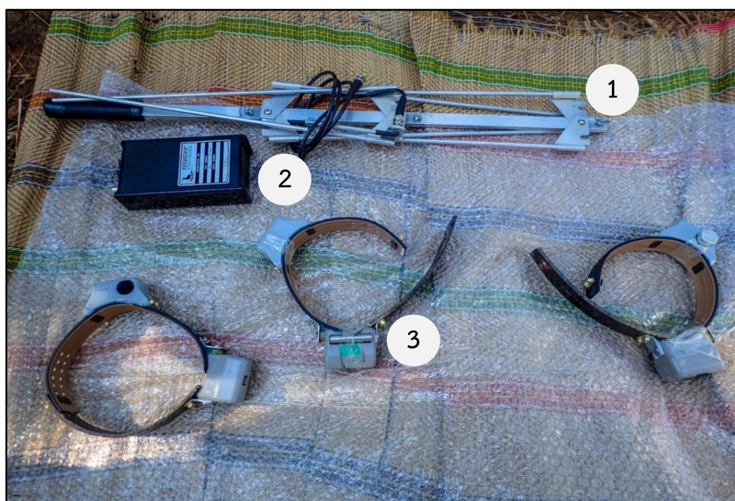
ภาพที่ 5 แสดงเครื่องมือที่ใช้ติดตามจากการติดปลอกคอสัญญาณดาวเทียม ประกอบด้วย (1) เสารับสัญญาณวิทยุ (Antena) (2) เครื่องรับสัญญาณ (Reciever) และ (3) ปลอกคอ หรือเครื่องส่งสัญญาณ
